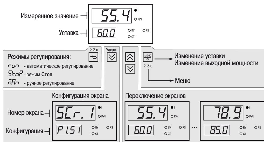
Рисунок 6.5 – Схема переходов с главного экрана
